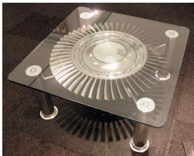
turbine en titane d'entrée d'air du moteur Rolls-Royce Pegasus monte sur l'avion à décollage vertical *Harrier*.
